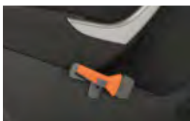
Staffa di fissaggio per la portiera dell'auto Clamp fastener for car door Quick Click System
