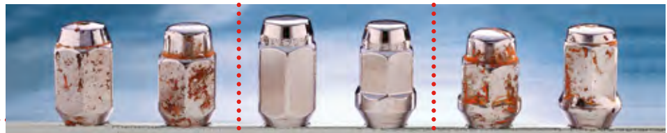
Risultato dopo circa un anno di esposizione (22 ore). Approx. 1 year of exposure, 22 hours.
