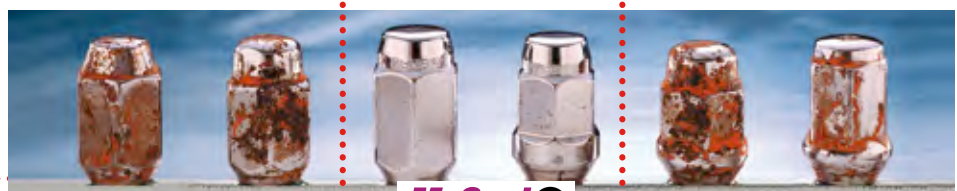
Risultato dopo circa cinque anni di esposizione (110 ore). Approx. 5 years of exposure, 110 hours.
