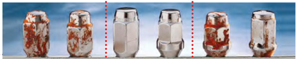
Risultato dopo circa tre anni di esposizione (66 ore). Approx. 3 years of exposure, 66 hours.
