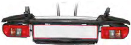
Alloggiamenti ruote e fanali estensibili Extendable wheel trays and lights
